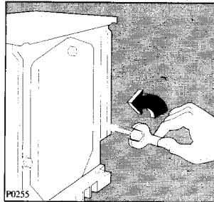
Отверните и снимите правый винт на задней стороне машины, используя для этого гаечный ключ. Наклоните машину назад (см. рисунок), не повредив при этом шланги. Проложите угольник упаковки между полом и машиной.
