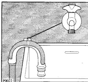
**Через край раковины.** Для того, чтобы конец шланга оставался в загнутом положении, используйте поставленное вместе с машиной пластмассовое направляющее устройство. Положение направляющего устройства не должно изменяться во время слива воды. Шланг должен быть прочно закреплен на месте либо с помощью настенного крючка, либо, например, посредством привязывания его к крану раковины.
