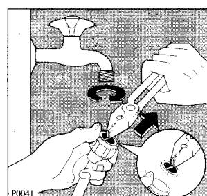
Если на заполнение машины водой уходит больше времени, чем обычно, следует проверить, не засорился ли фильтр чистой воды.
