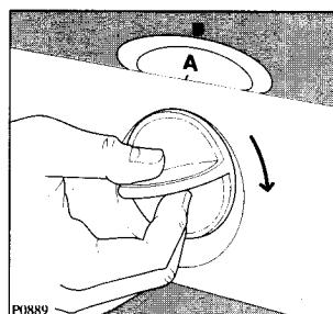
Поверните регулятор программы по часовой стрелке таким образом, чтобы его отметка совпала с соответствующей программой.
