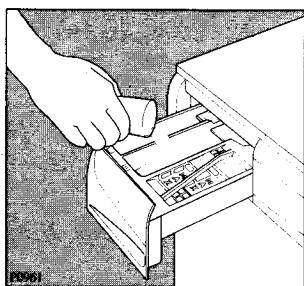
Выдвиньте дозатор наружу из контрольной панели. Отмерьте нужное количество моющего средства с помощью мензурки и засыпьте его в отделение стирки дозатора. Если хотите осуществить специальную предварительную
