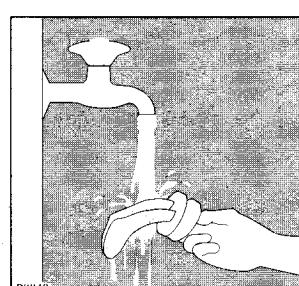
Промойте его проточной водой. Снова установите фильтр на место.
