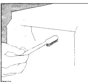
Моющее средство может также скапливаться в углублении дозатора, которое можно чистить, например, с помощью старой зубной щетки. После чистки дозатор следует вставить на место.
